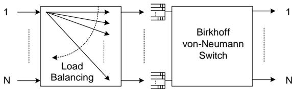
**Figure 11:** Load-balancing Birkhoff-von Neumann switch
